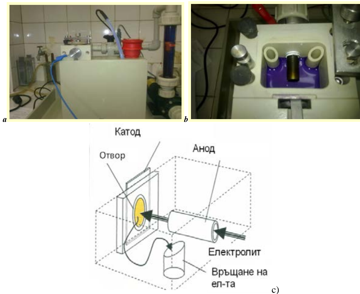
Фиг. 3.1. Експериментално оборудване за високоскоростно електроотлагане Jet-lab. (а) Общ изглед; (б) Работната клетка с кобалт-съдържащ електролит на дъното; (с) схема на работа на клетката
