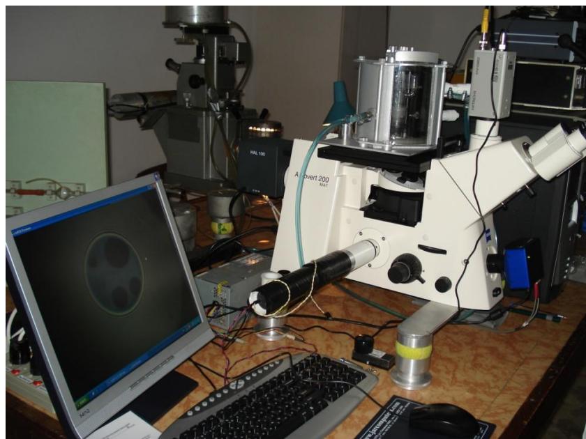
Фиг. П.9 Микроинтерферометрична апаратура, с микроскоп „Axiovert 200/MAT” - Carl ZEISS и снабдена със съвременен софтуер и хардуер за обработка на изображението.
