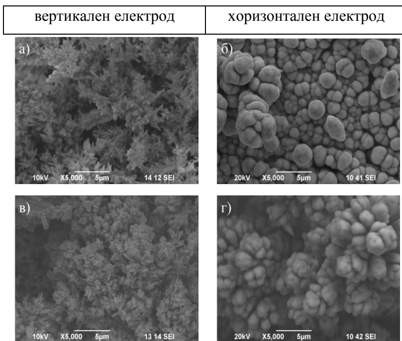
Фигура 53. Сравнителни SEM изображения на Ni-Cu покрития, отложени от Електролит V, съдържащ 0.2M NiSO 4 върху а) вертикален електрод при -4 A dm -2 , б) хоризонтален електрод при -4.5 A dm -2 , в) вертикален електрод при -6 A dm -2 , г) хоризонтален електрод при -5.5 A dm -2
