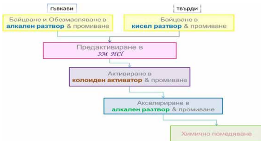
Фиг. 2: Технологична схема за обработка на подложките
