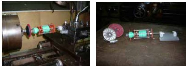
Фиг. 52: Устройството, на което бяха фиксирани (плоско-паралелно на повърхността на полиращия диск) полираните образци
