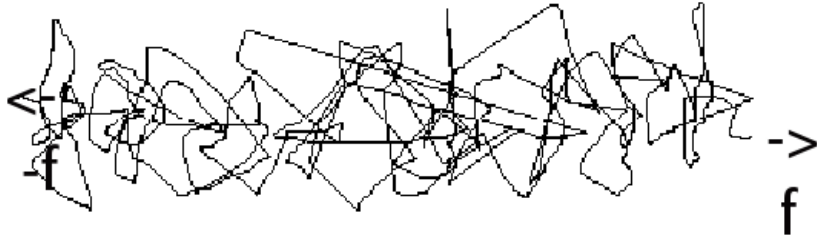
Фигура 1: Схема на Гаусова полимерна верига с приложена в двата края външна хомогенна сила f
