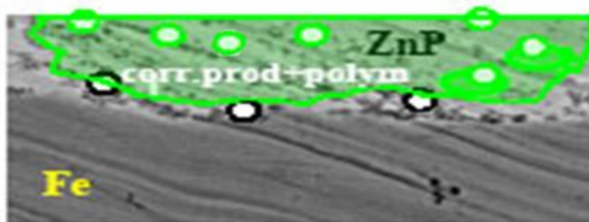
Фигура 40. Схема на появата на смесен филм от ПЧ и корозионни продукти при Zn композитно покритие с ПЧ (ZnP) в среда с хлорни йони
