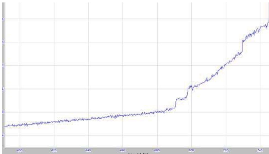
Фигура 8.3.4. Плътност на тока и приложени напрежения за филми от Abil (0.52%) в декан. Промяната на наклона на кривата е индикация за утечка на ток, непосредствено преди скъсването на филма (вертикален скок).
