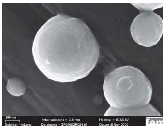
Фиг.30. Морфология на сплавни островни образувания на никел с Fe, P Co получени при потенциостатичен импулсен режим.
