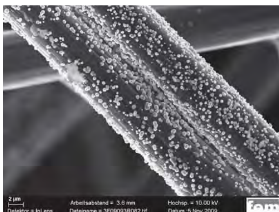
Фиг.30. Морфология на сплавни островни образувания на никел с Fe, P Co получени при потенциостатичен импулсен режим.
