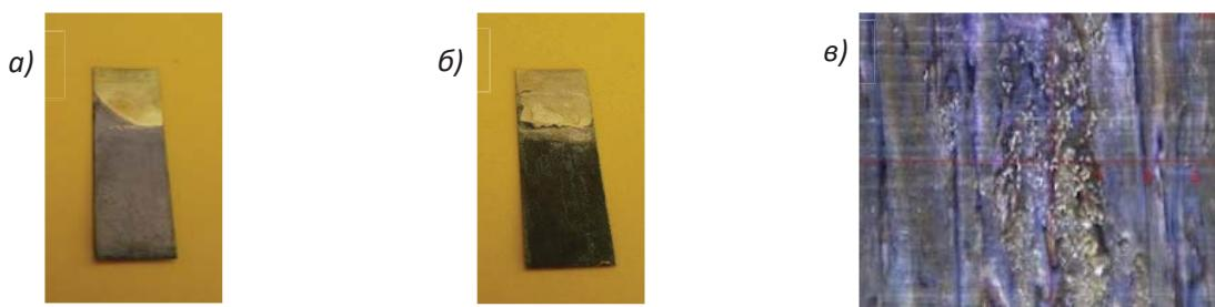
**Фиг. III-4.** Снимки на образци с отложени сплавни покрития мед-антимон от пирофосфатен електролит В при (а)  $0,1 \text{ A/dm}^2$  и (б)  $0,5 \text{ A/dm}^2$ .
